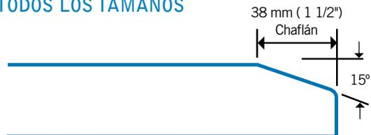
Aplique un recubrimiento delgado de lubricante (alrededor de 1 mm de espesor, equivalente a un recubrimiento cepillado) usando un guante, un trapo, o una brocha. El área que se cubrirá es como sigue:
